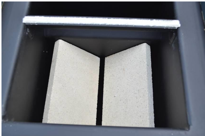
Slika 5.4. Postavljanje vatrostalne opeke u komoru za sagorevanje kotla
